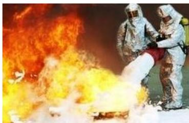
L'émulseur concentré **PROSINTEX** est basé sur une formulation particulière de tensioactifs synergiques et de sels stabilisateurs qui permettent d'obtenir une mousse à plasticité très élevée et une fluidité remarquable, telle que de larges surfaces peuvent être rapidement couvertes même en présence d'obstacles.
